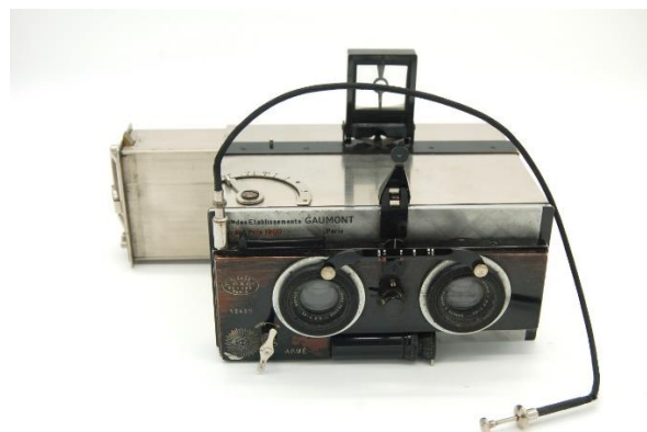
Vue de dessus avec le compteur de plaques et vue de face avec le magasin de plaques partiellement retiré
