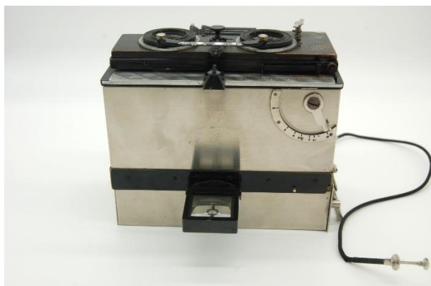
Vue de dessus avec le compteur de plaques et vue de face avec le magasin de plaques partiellement retiré
